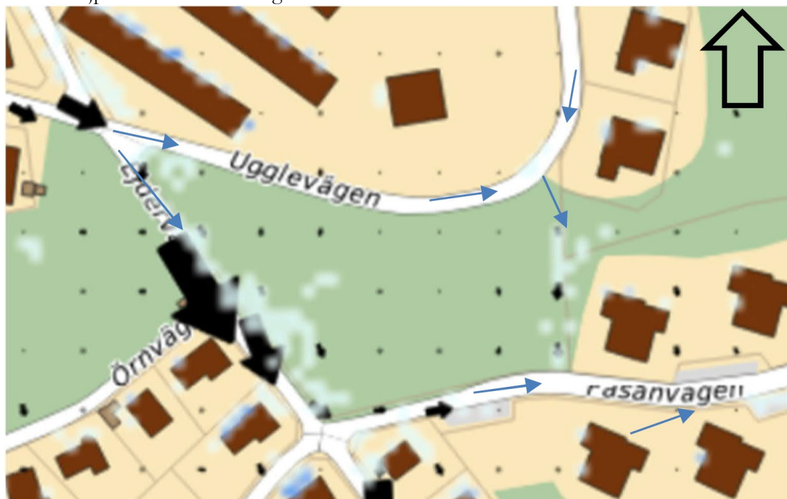
Figur 15. Förstorad vy av detaljplaneområdet hämtat från Nacka Stads Skyfallsanalys för ett 100-års regn med klimatafaktor 1,2. Blå och svarta pilor visar yttliga flödesvägar baserade på en topografisk analys.
